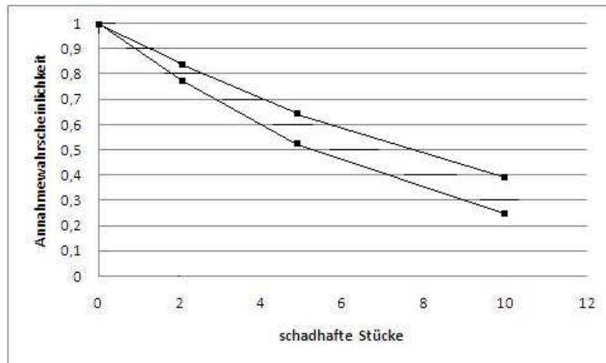
Der Graph der Operationscharakteristik von Ip6 verläuft vollständig unter dem Graphen von Ip4.
